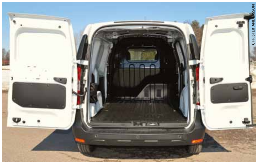
Lika rymligt skåp som sina konkurrenter, 3,3 kubikmeter. Plåttrent med små lastsäkringsöglor. 654 kilo maxlast.
