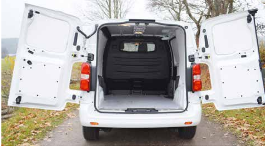
Symmetriskt öppnande bakdörrar som inte spärrar i 180 graders öppning. Sex lastsäkringsöglor vilka är i minsta laget. Genomlastningslucka till passagerarutrymme. Sidodörren är smalare jämfört med de längre Expert-versionerna.
