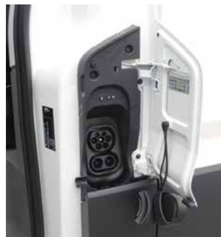
Anslutningen av laddkabeln till e-Craftern göms under samma tanklock vid förardörren som används vid tankning av diesel. En laddindikeringslampa lyser och laddkontakten spärras. Måste låsas upp med bilnyckeln.
