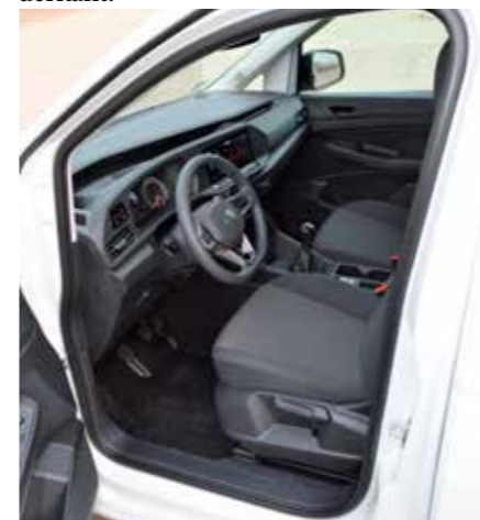
Inredningen är ny och panelen har analogt avläsbara digitala instrument och 8-tums-skärmen, standard i Sverige, har touchkontroller. Bra förvaringsutrymme, men för kort skärm över förvaringen på panelen ger speglingar i rutan.
