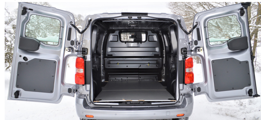
Bakdörrarna spärrar inte när de öppnas i 180 grader. Sex lastsäkringsögglor. En genomlastningslucka ger åtkomst till utrymmet under passagerarsoffan.
