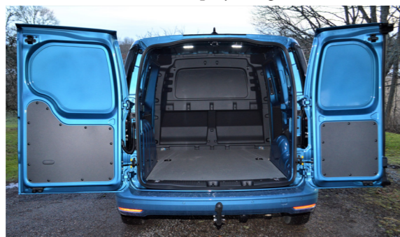
Träggolvet är standard i Sverige. Sex lastsäkringsöglor. Bra ledbelysning i taket. Tyvärr tillval. De asymmetriska sidohängda dörrarna spärrar fortfarande inte när de öppnas i 180 grader.
