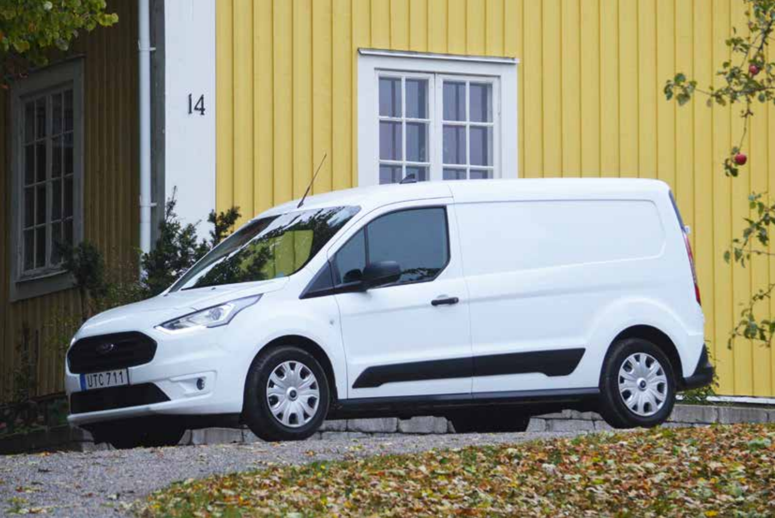
Transit Connect har lackad stötfångare fram i Trend-utförande. Vi föredrar den mattsvarta på billigare Ambiente. Ingen strålkastarspolning. På bilden den långa versionen olastad. Maxlastad sätter sig Connect cirka 9 cm.
