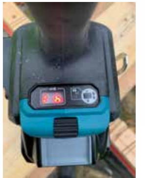
Makita DF001 GM201 har elektronisk momentinställning
